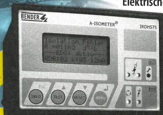
Isolationsüberwachung • Fehlerortlokalisierung • Präzise Messtechnik: **AMP<sup>Plus</sup>**- Messverfahren • Einfache Bedienung
