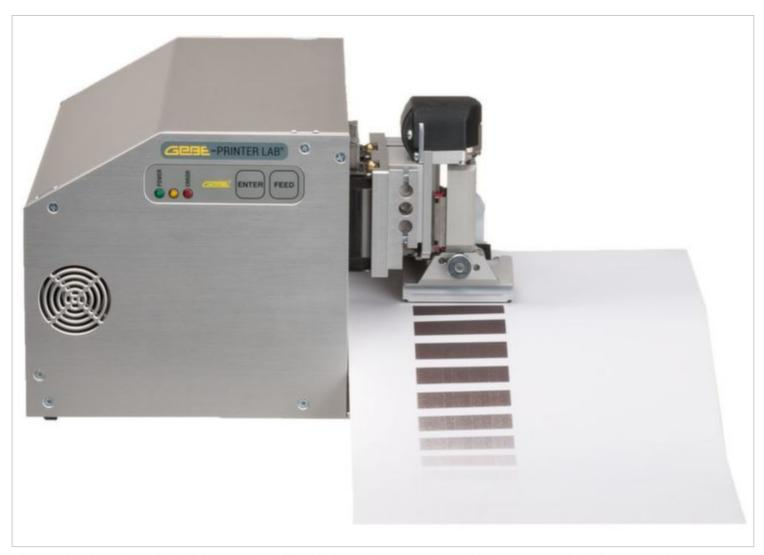
Thermodruck: Wie verhält sich unterschiedlich dickes Thermopapier während des Drucks bei verschiedenen Bedingungen? (Bild: GeBE)
